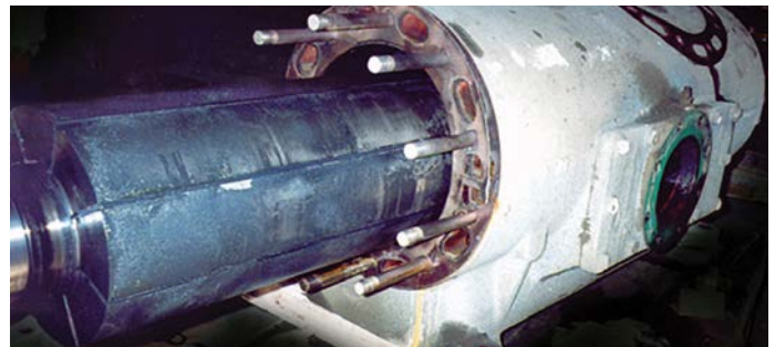
Rotor del compresor antes de la restauración
